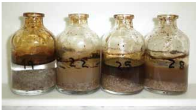
Figura 1 – Aspecto visual da degradação do petróleo após 15 dias de incubação em água do mar. Frascos nº 19: atenuação natural; 22: bioestimulação; 25: bioaumento; 28: bioestimulação + bioaumento.
