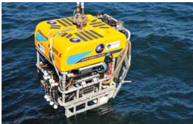
Figura 2 – O ROV “Luso” a iniciar um mergulho. São visíveis as garrafas Niskin, o tubo do sistema de aspiração, um dos braços robóticos e vários sensores.
