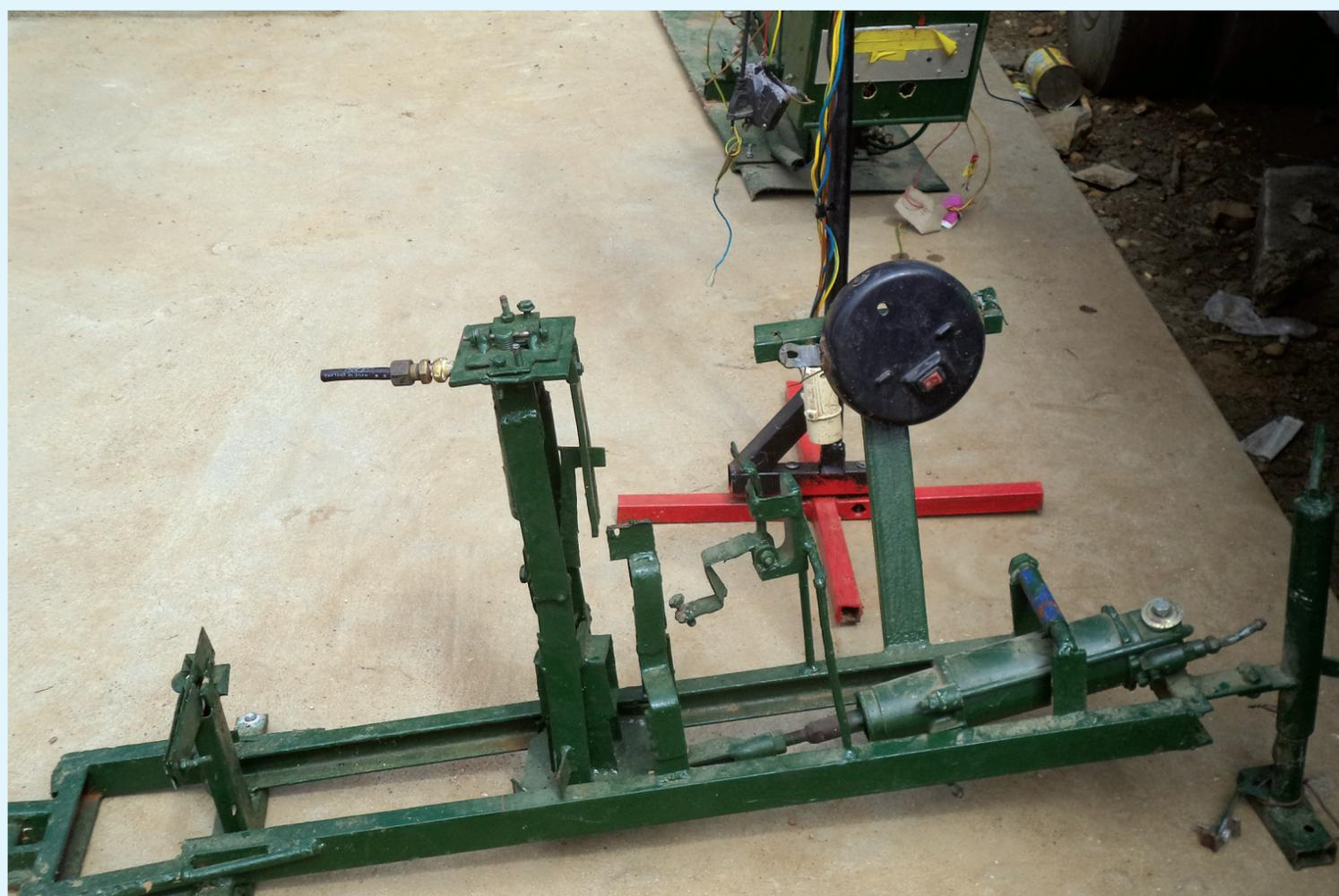
“Tem a função de corte com o metal a deslizar sobre um tubo que serve de guia. Depois da acção, de imediato, dá-se colocação de outro ferro para o mesmo exercício. Contudo, no invento ainda não está integrado
