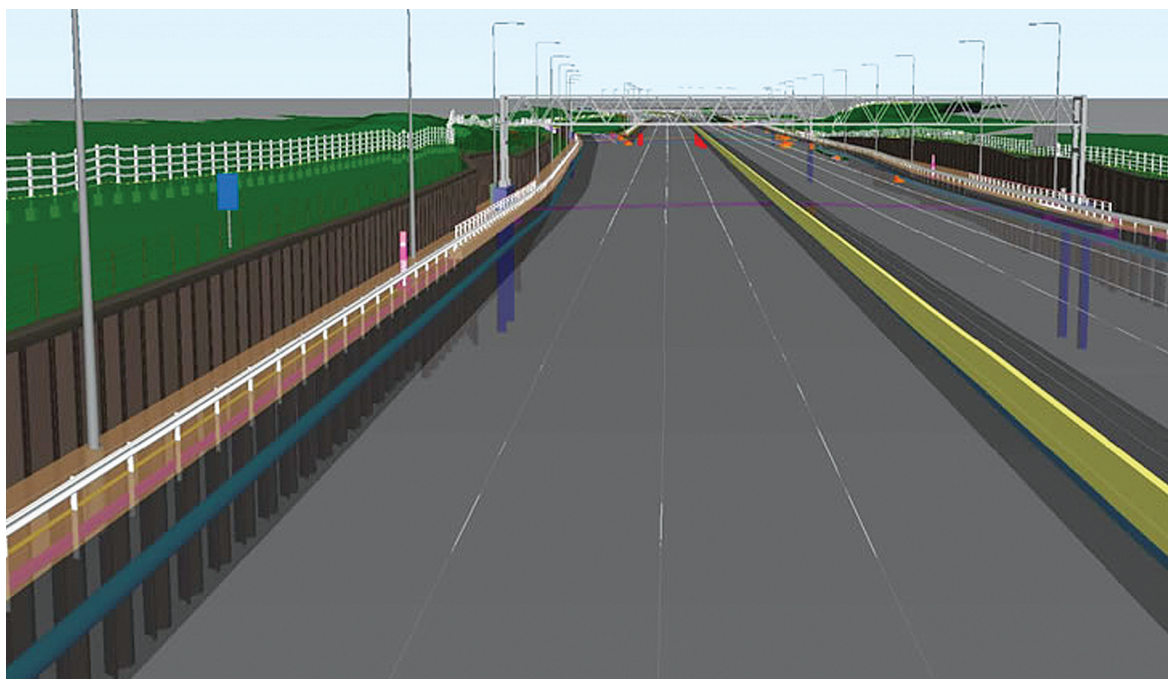
O modelo projectado em Civil 3D, depois de validado para construção, foi transferido para o Navisworks, permitindo uma gestão eficaz da obra e, ao mesmo tempo; melhorar a intenção de projecto, através da introdução de alguns elementos realistas.
