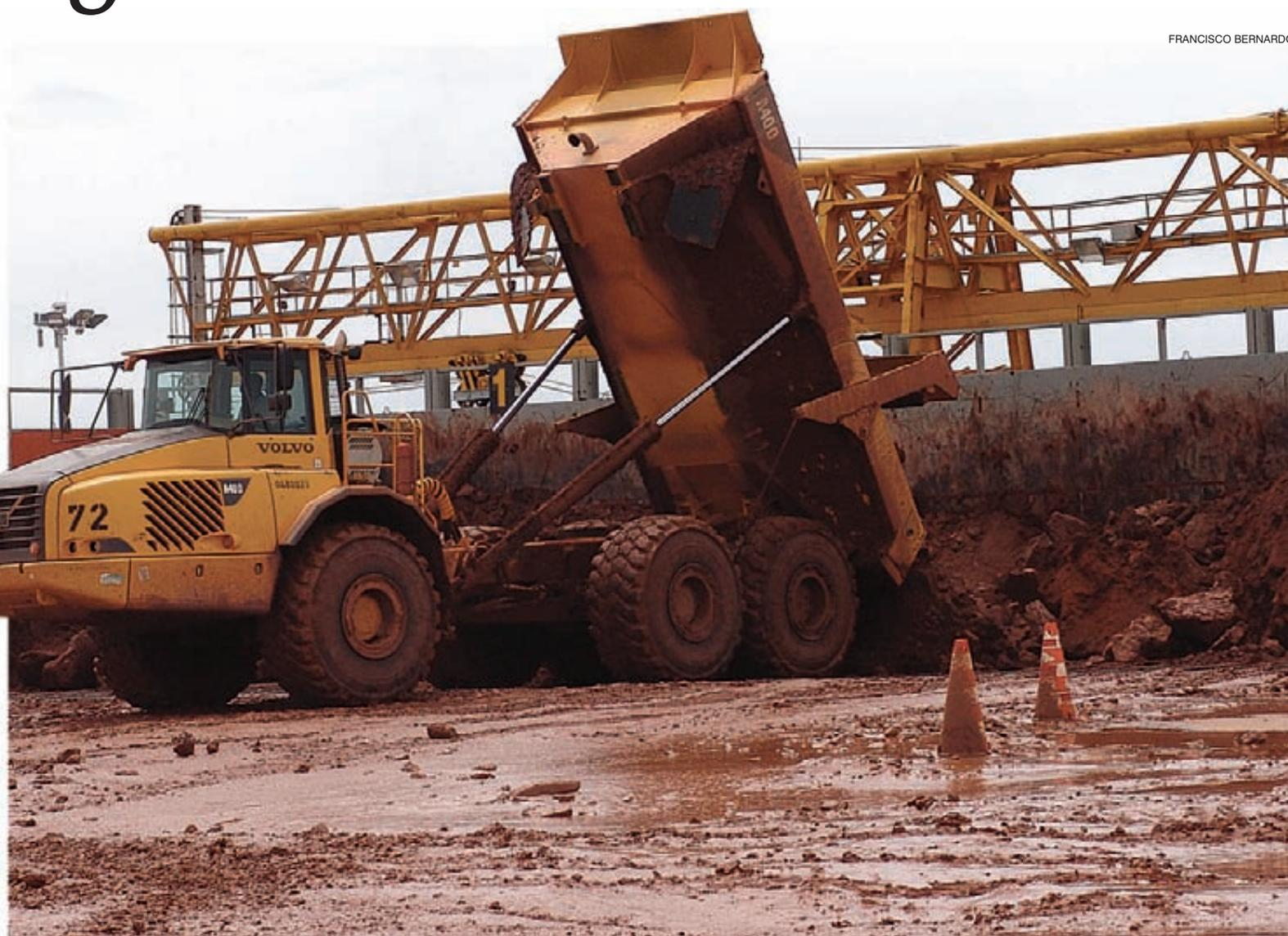
Modelo de viatura utilizada pelo projecto Catoca no momento em que descarregava o cascalho transportado da mina para o primeiro sistema de desintegração de inertes
